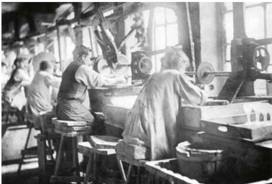
Glasslijpers aan het werk in de glasfabriek van Sphinx, omstreeks 1887. Het effect van de bewerking kon bij daglicht het beste worden beoordeeld. SHCL, fotocollectie Sphinx-C eramique.
