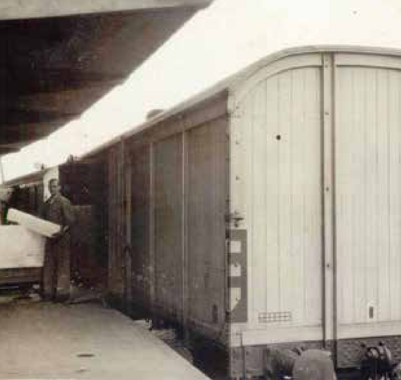
Op het laadbordes aan het spoor is een medewerker bezig met het laden van ijsstaven in een wagon. Om de boter gekoeld bij de klant te kunnen afleveren, werden de wagons met behulp van ijsstaven onder de maximum toelaatbare temperatuur gehouden. Dit ijs werd in de kelder van het Zuid-Nederlandsch Koelhuis geproduceerd. Coll. L. van Laer te Roermond.
