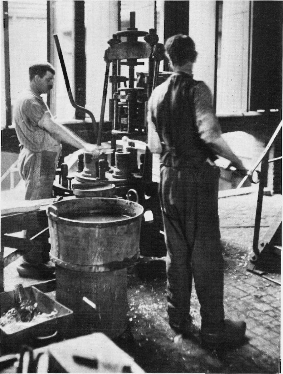
Het mechanisch vormen van een drinkglas in een ijzeren gietvorm. De arbeider links zal de glasstroom met een schaar onderbreken. Daarna zal met de pers een drinkglas worden gevormd.
