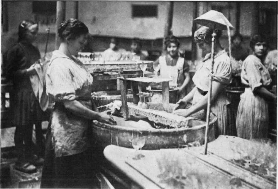
De scherpe randen van de glazen worden met behulp van een horizontaal geplaatste slijpsteen bewerkt. Vermoedelijk is de verticale staaf met kap een toen al ouderwetse gaslamp met een open vleermuisvormige vlam.
